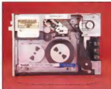
Il montaggio interno richiede la compressione di alcuni cavi; si può notare quello di alimentazione già pre-istallato (foto di sinistra). Grazie ad un sistema di levoregole la protezione del nastro da 1/4 di pollice viene rimossa automaticamente inserendo la cartuccia (foto di destra).
